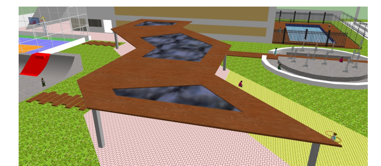
08 Cobertura da área esportiva do conjunto. A cobertura possui uma forma que se assemelha ao perfil dos edifícios e é feita em madeira, com "rasgos" em policarbonato.
